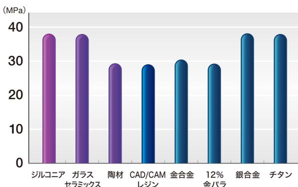
測定条件: サンドブラスト処理(ジルコニア、金属、CAD/CAMレジン)、#1000研磨(陶材、ガラスセラミックス)、被着面積:5mm<sup>2</sup>、被着体に本品適用後、「パナビア® V5ペースト」を塗布して圧接し、マージン部へベンキュア2000で2方向から10秒光照射
