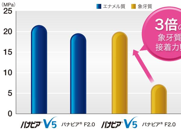
測定条件: 牛歯#1000研磨面、被着面積3mm<sup>2</sup>、化学硬化37°C水中に1日浸漬後、測定
